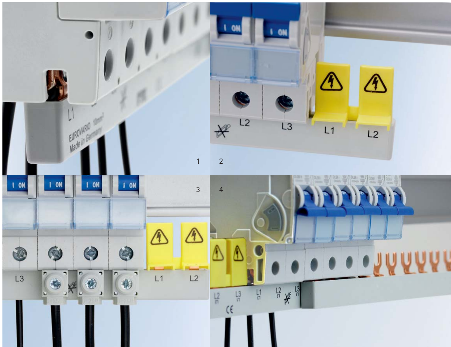
zdjęcie 1: zintegrowana zaślepka | zdjęcie 2: osłony ochronne dla nieużywanych pól | zdjęcie 3: zastosowanie z połączonymi zaciskami | zdjęcie 4: wzajemne połączenie kilku szyn eurovario
